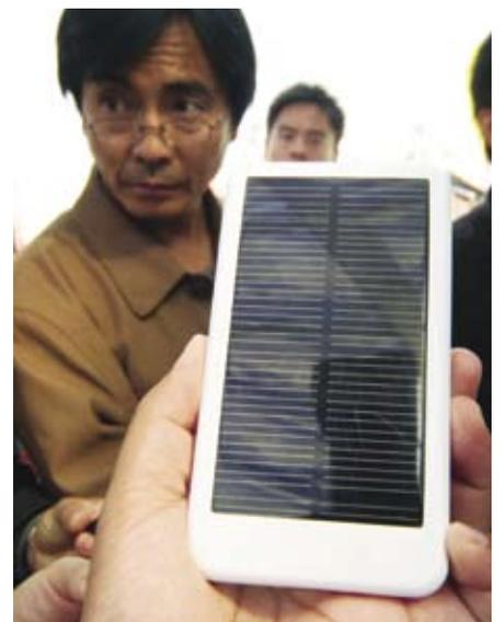
Este celular funciona hasta 40 minutos continuos luego de cargarse una hora con energía solar.
